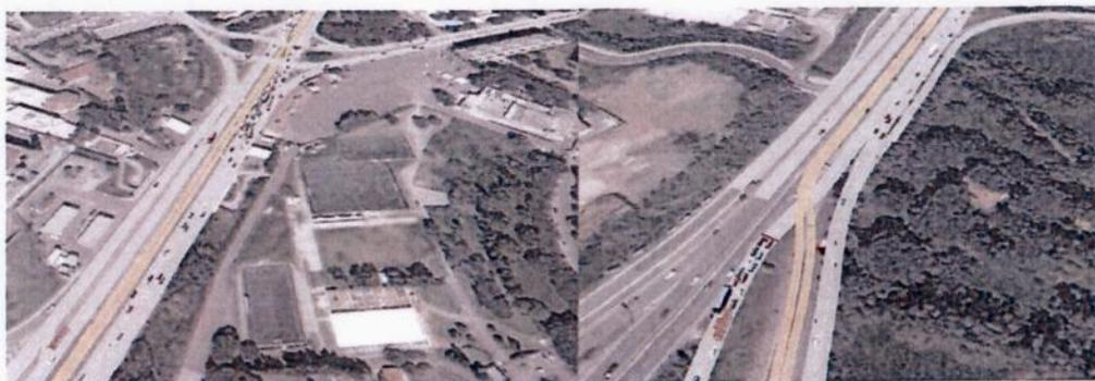
Le code di Via Cristoforo Colombo e Via Pontina in attestamento all'impianto semaforico di Piazzale 25 Marzo 1957, nello scenario sopra indicato, sono dell'ordine massimo di 260m, valori non critici per il tronco di scambio nella configurazione simulata, in quanto corrispondenti ad un riempimento di circa il 50%.
